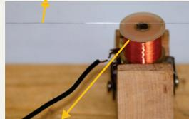
2 Cuando se las hace vibrar, inducen una corriente eléctrica en una bobina (la pastilla o pick up) que se encuentra dentro de la caja de la guitarra, bajo las cuerdas.
