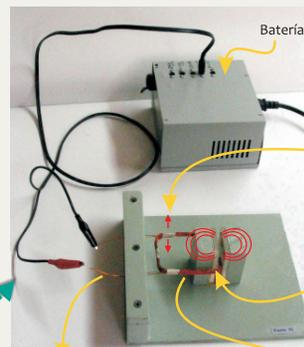
Alambre con el que está hecha la bobina, conectado a una batería.
