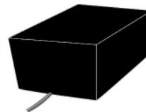
Colocar todo dentro de la caja, de modo que esta quede apoyada sobre una superficie lisa, con el cable de la cámara saliendo por la muesca, tal que no entre luz.
