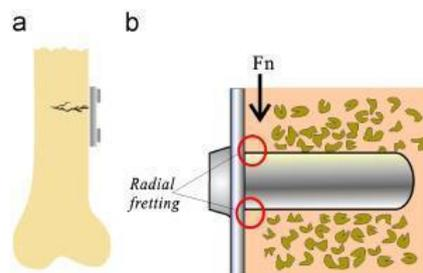
Diagrama esquemático del tornillo utilizado en una placa de osteosíntesis: (a) esquema del sistema tornillo/placa en una fractura; (b) fretting radial producido por las variaciones de carga  $F_n$  al moverse el paciente [3].
