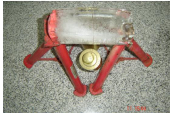
nuevamente sobre el alambre. Sólo que al solidificarse, cede la suficiente energía como para fundir una cantidad igual de hielo bajo el alambre. Al finalizar el proceso, el alambre caerá atravesando la barra de hielo, que quedará entera.
