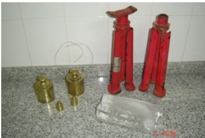
Con ayuda de una caja de vino y un freezer, se fabrica la barra de hielo. Los extremos del alambre de cobre se atan a las pesas. Luego se apoyan los extremos de la barra de hielo en los trípodes y sobre ésta se coloca el alambre con las dos pesas.
