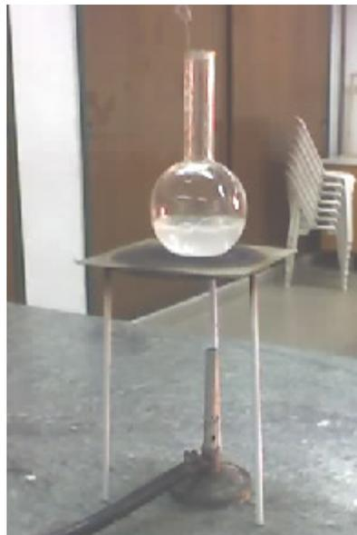
Cuando el vapor salga libremente, bajamos un cascabel suspendido de un hilo adentro del balón y tapamos el recipiente con un tapón. Quitamos la fuente de calor inmediatamente y dejamos que el balón se enfríe. Colocamos un cascabel semejante dentro del otro balón y lo tapamos como hicimos con el primero.
