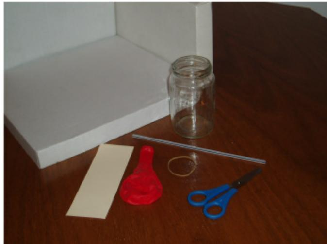
Mi experimento consiste en cubrir la boca de un frasco de vidrio con la parte inferior de un globo, para ello es necesario cortarlo a la mitad, de modo que quede herméticamente sellado.
