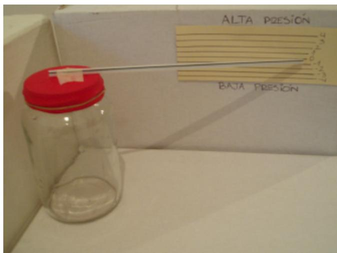
Para llevar a cabo el funcionamiento de este barómetro, lo coloque en un lugar con sombra, donde no se puedan observar cambios de temperatura, para así evitar que se puedan modificar negativamente los resultados del barómetro
