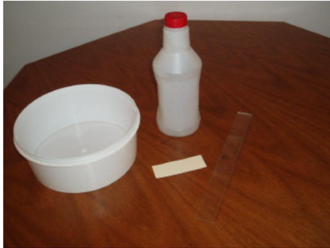
El procedimiento consiste en llenar la botella de agua y colocarla invertida dentro de un plato con agua, evitando que se salga el agua de la botella y colocando el soporte para detenerla. La tira de cartulina, una vez milimetrada para utilizarla como escala, adherirla a la botella.
