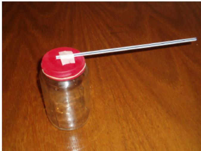
Utilice las tiras de cartulina, como una escala, marcando líneas dejando 0,5 cm entre ellas y escribí “Baja presión” en la parte inferior y “Alta presión” en la parte superior. Y por último, coloqué el barómetro y la escala dentro de la caja de cartón, de modo que el extremo del sorbete llegue a la escala.
